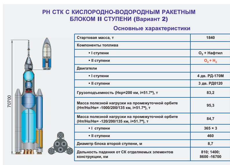
жидкостному ракетному двигателю РД-170М разработки НПО «Энергомаш» (на которых реализуются мероприятия по совершенствованию системы регулирования как на двигателе РД-171М, применяемом на первой ступени РН «Зенит»). На блоке второй ступени установлены три кислородно-водородных однокамерных двигателя РД0120 разработки КБХА, которые применялись на блоке Ц ракеты-носителя «Энергия».
