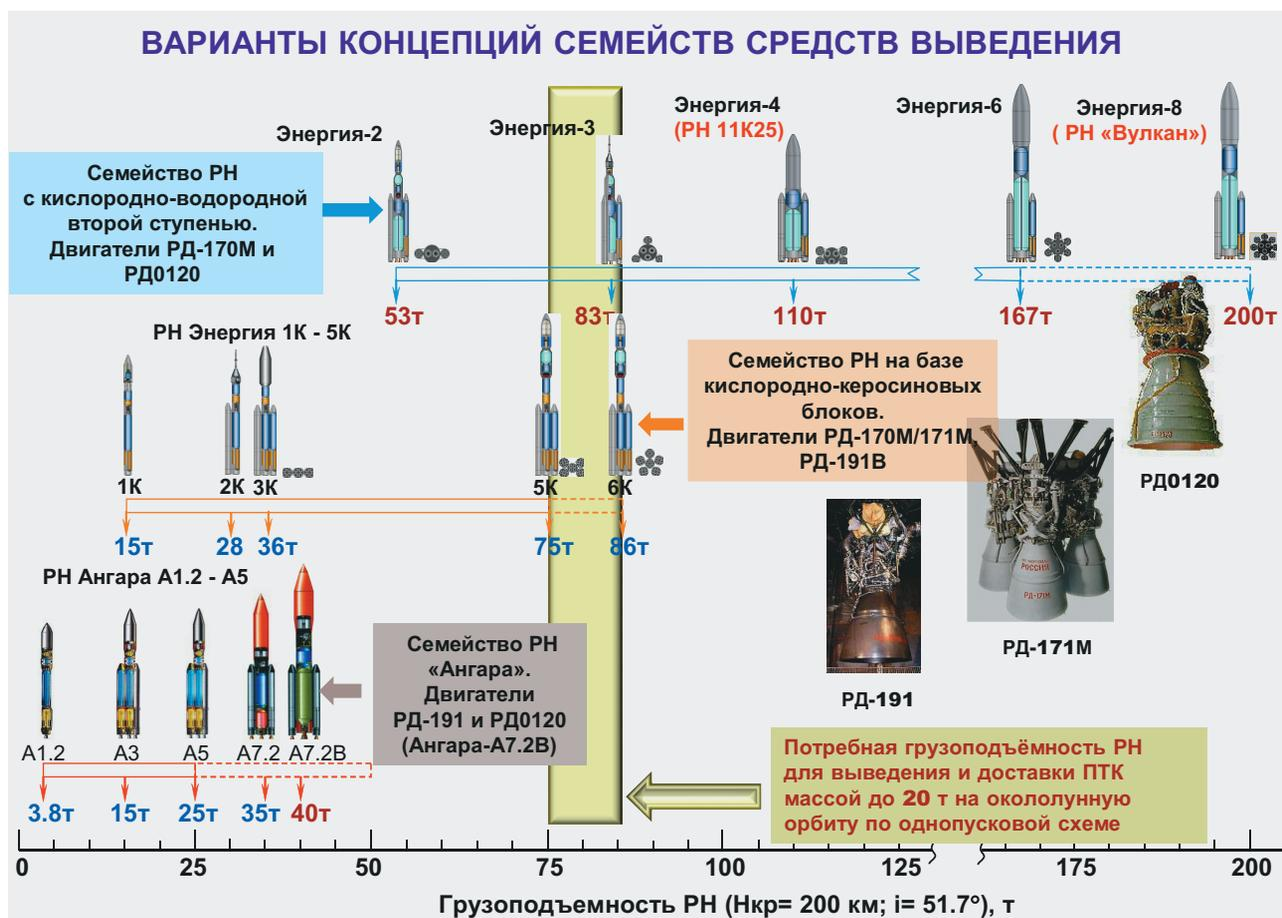
При разработке РН «Энергия» в НПО «Энергомаш» был создан самый мощный жидкостный кислородно-керосиновый ракетный двигатель РД-170 с тягой (на Земле) 740 тс.
