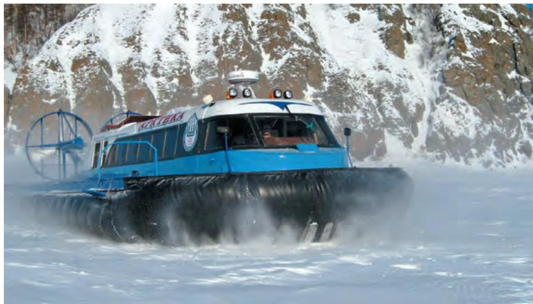
*Разработанная омскими учеными амфибийная грузовая платформа на воздушной подушке «Арктика» поставлена на вооружение армии РФ.*
