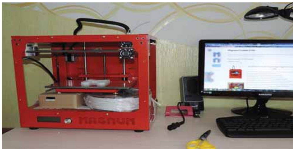
3D-принтер Magnet российского производства для изготовления небольших пластмассовых изделий.
