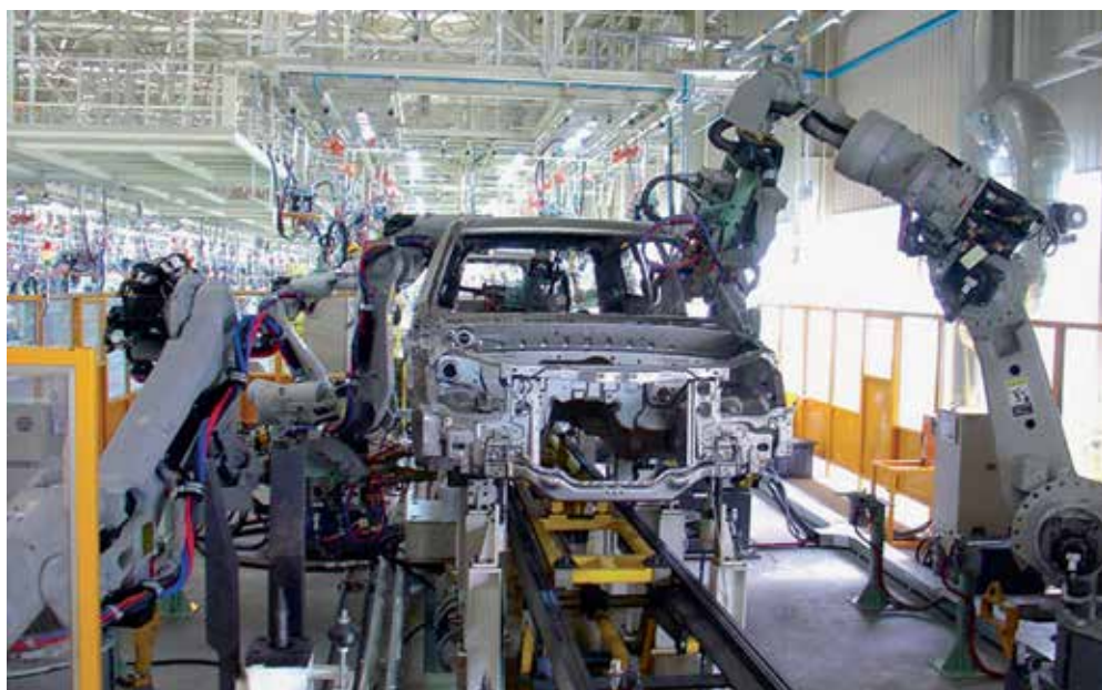
Автоматизированная сборка автомобилей при помощи роботов в Японии.
