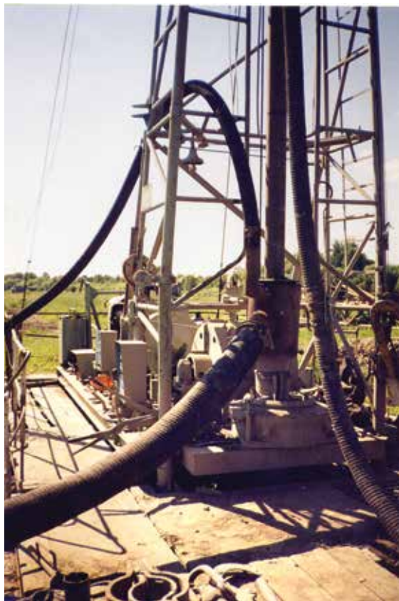
Эрлифтный снаряд для добычи цирконовых песков на Тарском месторождении, Омская область.
