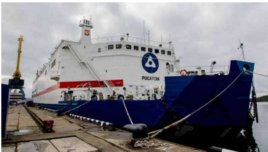
Рис. 7. Российская плавучая атомная электростанция «Академик Ломоносов».
