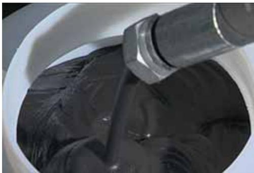
*Рис. 8. Водоугольная суспензия в жидкой форме.*
