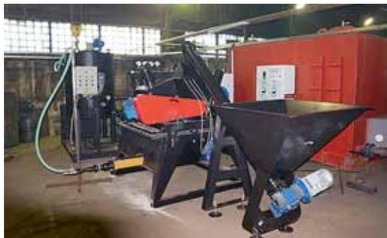
Рис. 10. Примерная компоновка котельной. Узел приготовления ВУТ (ГУУМП) – на переднем плане, ёмкость хранения ВУТ (слева) и котёл мощностью 1МВт (справа).
