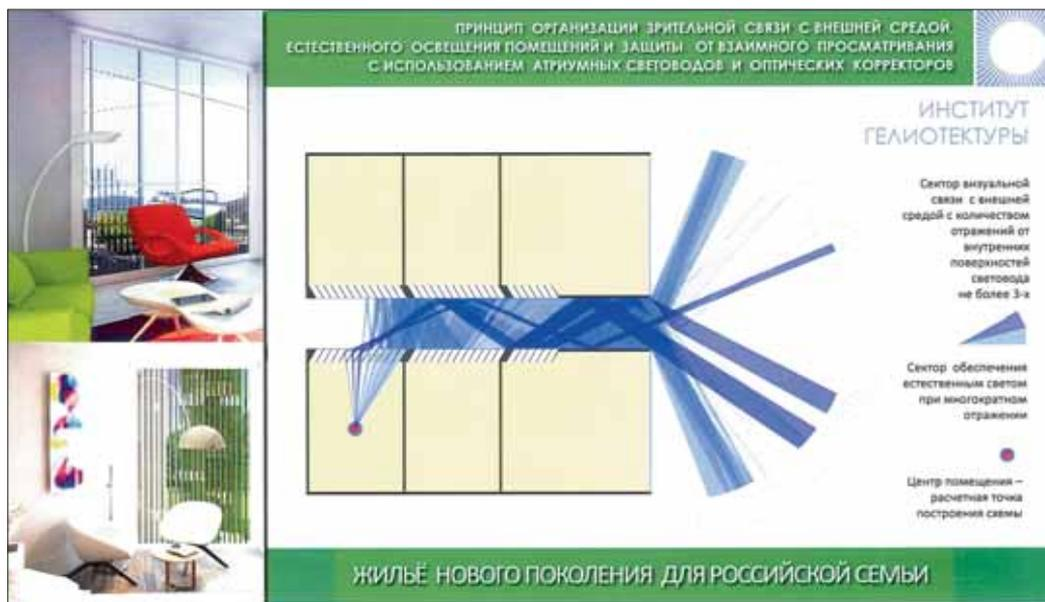
Рис. 17. Плоский вариант атриумного световода с оптическими корректорами.
