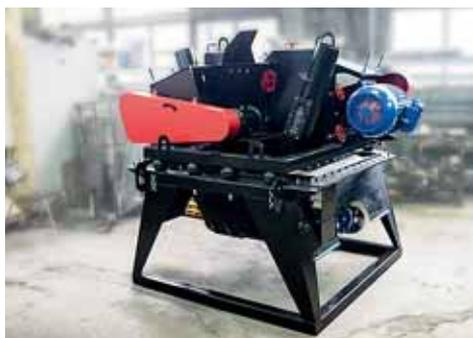
Рис. 9. Гидроударный узел для производства ВУС.
