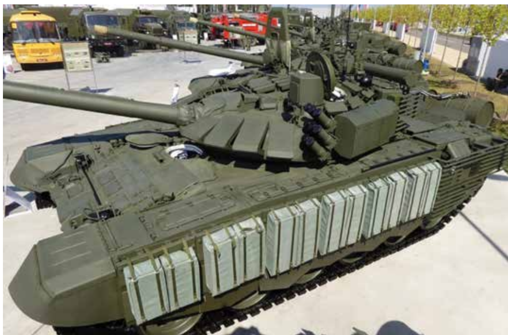
Танк Т-72Б3 с комплексом динамической защиты.
